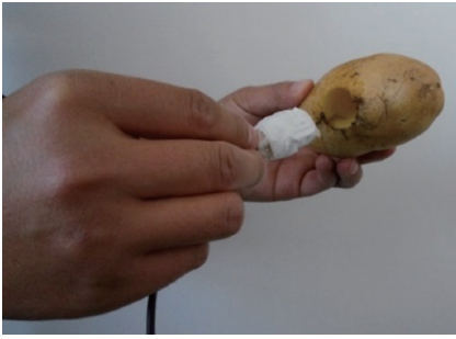
图 2 加速度传感器的安装
