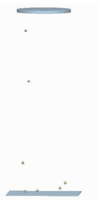
图7 种子与底板碰撞过程的离散元仿真
