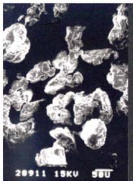
图1 铁粉扫描电镜照片
