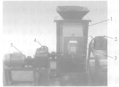
1. 取样装置; 2. 二次侧系统; 3. 电容式水分传感器; 4. 无级变速器; 5. 单相电机
