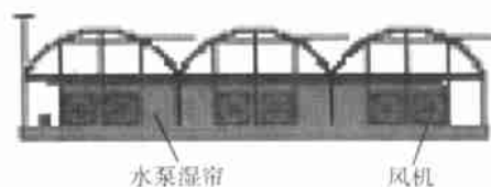
图4 降温过程中水泵湿帘和风机运行的模拟结果
